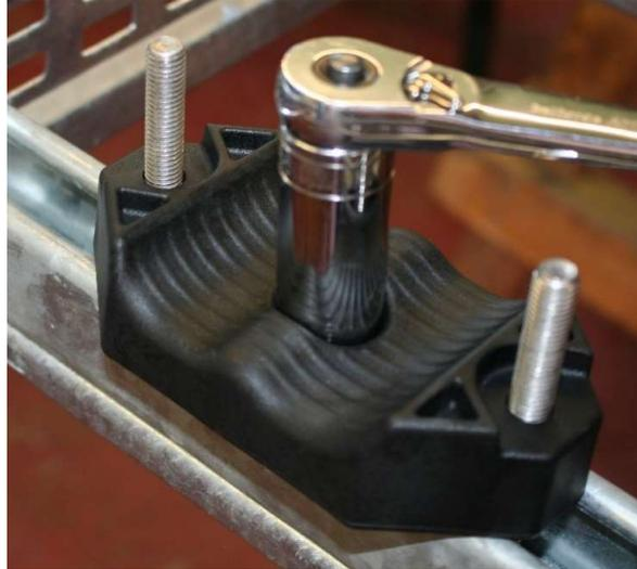
1b) Ponga la base de la abrazadera sobre la superficie de montaje y ponga las fijaciones 2 x M10/M12 a través de la base de la abrazadera y la estructura de montaje. Para mantener la base por debajo antes que la parte superior sea instalada, la base necesita estar fijada con dos tuercas 2 x M10/M12 en los huecos previstos( como detallado en la imagen a la derecha).
