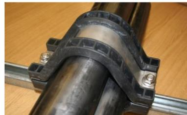
PS: Afin d'éviter que les vis et les écrous en acier inoxydable A4 ne se bloquent durant le vissage, ne pas utiliser une pression et vitesse excessives durant le serrage. Des lubrifiants peuvent également être utilisés au moment du vissage - merci de contacter Ellis Patents pour plus d'information.
