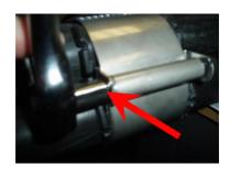
Apriete la tuerca polimérica al otro borde del perno con una llave de 10 mm, sacando el perno a través del marco de ensamblaje.
